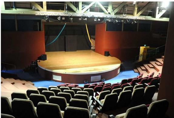
Come dotazione tecnica c'è un **impianto audio** (mixer, amplificazione e casse acustiche) e un **impianto luci** (americana sopra il proscenio attrezzata con 9 PC da 1KW, dimmer 12 canali, mixer 12+12 canali, possibilità di collegare altri dimmer e proiettori - non forniti - sia in posizione frontale che di taglio o in controluce).
